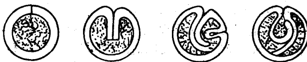
图0-14 药芯焊丝截面形状示例
