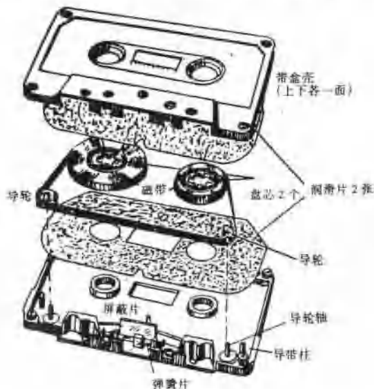
图17 盒式磁带内部结构
