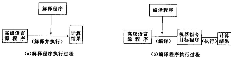
图1-4 解释程序和编译程序执行过程
