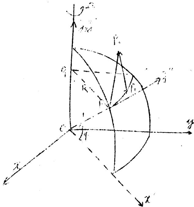
设初始时刻大气流体质点位于  $P$ ,  $\delta t$  时刻后运动到  $P_2$  (在地球惯性坐标系中观察), 于是有  $\overrightarrow{PP_2} = \vec{v}_a \delta t$ , 其中  $\vec{v}_a$  为在地球惯性坐标系中大气流体质点的运动速度。但这时, 由于地球的旋转, 起始位置  $P$  已移动到  $P_1$ , 因此 从地心旋转坐标系来看, 流体质点是从  $P_1$  运动到  $P_2$  的, 故有  $\overrightarrow{P_1P_2} = \vec{v} \delta t$ , 其中  $\vec{v}$  为在地心旋转坐标系中流体质点的运动速度。另外,  $\overrightarrow{PP_1} = \vec{v}_e \delta t$ , 其中  $\vec{v}_e$  为  $P$  点的牵连速度。显然  $\vec{v}_e = \vec{\omega} \times \vec{r}$ ,  $\vec{v}_e = \frac{d\vec{r}}{dt}$
