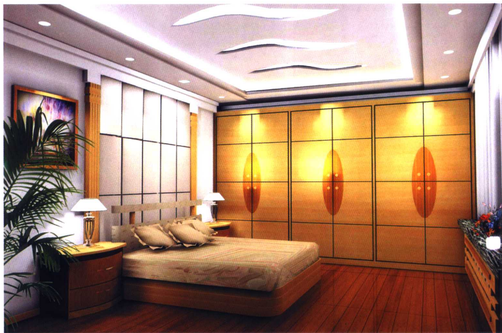
两侧线、面构成简洁的柱式，中间石膏板抽缝构成大的块面，天花曲线强调了动感。 /徐静
