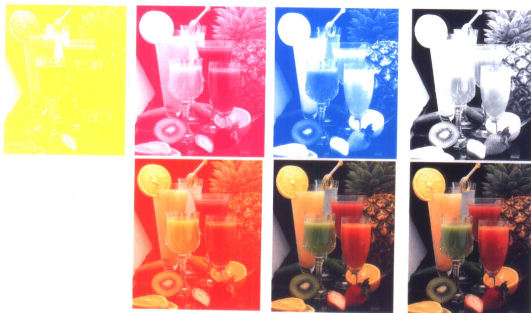
彩图 22 胶版印刷中的空间叠加原理
