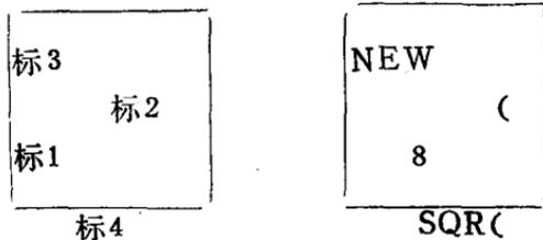
案，可用小图案组成各种图形。设在标2处。用时需先按住移位键**SHIFT**，再按所需符号键或图案键。
