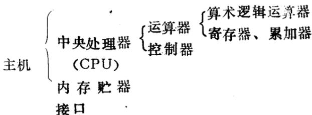
中央处理器是电子计算机的核心，由它产生各种指令，并以此控制计算机的运行。CPU的振荡频率决定计算机的速度。
