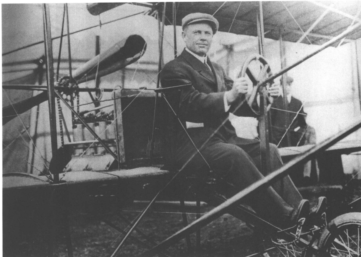
托马斯·斯科特·鲍德温 (Thomas Scott Baldwin) 是一位特技演员，气球驾驶员和轻型体育航空器发展先驱。图为他双手握住自行建造的，名为“红魔鬼” (Red Devil) 的推进器驾驶盘。此推进器的前部有一个三角形的起落架，尾部有滑梯。图中的推进器，可能就是他于 1911 年在香港使用过的。
