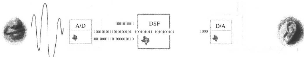
图 1-1 数字信号处理系统简化框图
