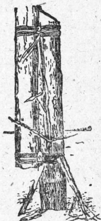
图 2—4 雷击使木杆綁桩劈裂
