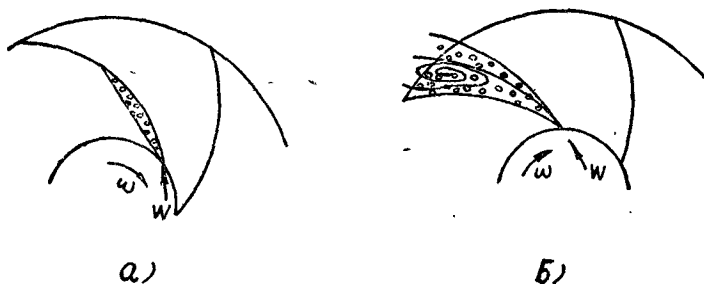
图 1-8 冲角 \alpha_y 的确定
