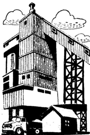
巨大的装料机抡起它那粗壮的钢臂，毫不费力地将一斗一斗砂、石铲起来，扔进张口等着的贮料槽，然后，长长的皮带运输机把它们提升到高高的混凝土搅拌楼上。用不多一会儿工夫，停在搅拌机下面的自卸汽车就满载着搅成的混凝土驶向建筑施工工地。
