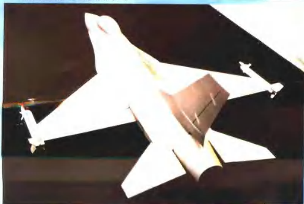
风洞实验用的全金属标准模型
