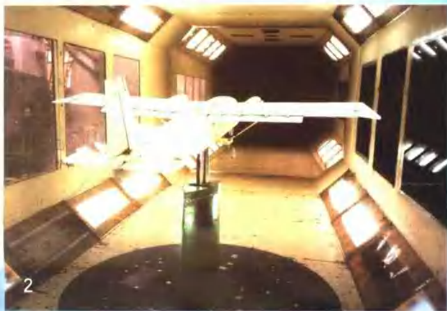
在大风洞中的 运-12飞机模型
