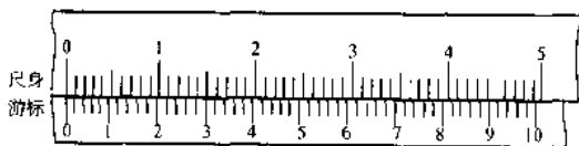
图 1—4 1/50\text{ mm} 游标卡尺刻度线原理
