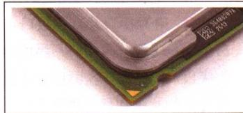
■ 缺角是 CPU 安装方向的标识，安装时应与主板 CPU 插槽上的标识保持一致。
