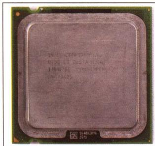
■ CPU 封装是采用特定的材料将 CPU 芯片或 CPU 模块固化在其中以防损坏的保护措施。
