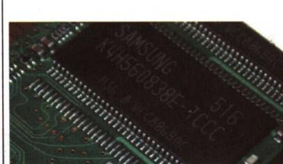
■ 存储颗粒是内存的核心元件，决定内存的容量、规格、性能等重要参数，表面印刷有生产厂家、编号等信息。内存颗粒有多种封装方式，目前较新的是 BGA 封装方式。
