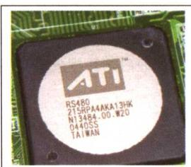
■ 北桥芯片，负责与 CPU 的联系并控制内存、AGP、PCI 数据在北桥内部传输。
