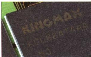
■ 独特的 TinyBGA 封装，与传统的 TSOP 封装相比，T-BGA 封装有更好的电器性能，可以应付更高的运行频率。
