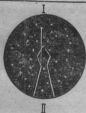
图 1—2 闪烁镜 I 闪烁示意图 II 屏上产生萤光的示意图
