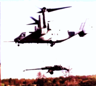
美国的“鱼鹰”V-22偏 转旋翼飞机吊运火炮
