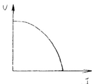
为了容易引弧和保证电弧的稳定燃烧，焊接电源的空载电压要尽量高一些，但是，从经济观点来看，特别是从焊工的安全角度来考虑，空载电压愈低愈好。为了同时保证上述几点要求，目前我国用于手工电弧焊电源的空载电压，交流的在55~70伏，直流在45~70伏（不超过90伏）。工作电压则在20~30伏左右。
