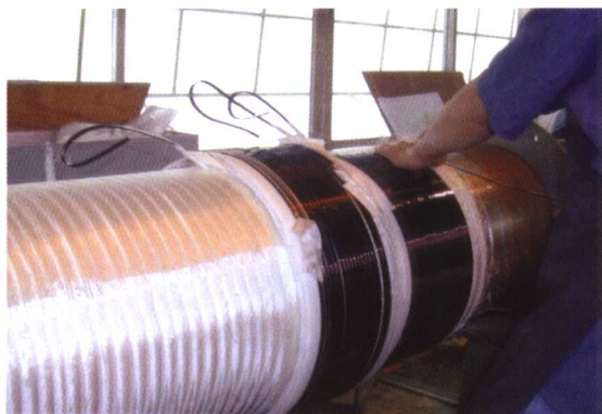
图 3-16 绕制中的分段圆筒式绕组
