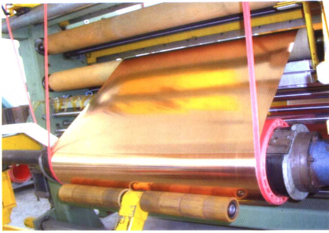
图 3-18 在箔绕机上绕制的绕组
