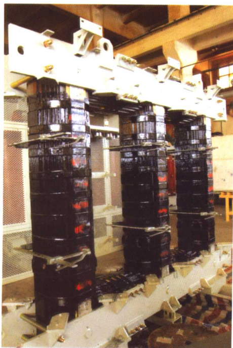
图 3-7 大容量环氧浇注干式变压器铁心
