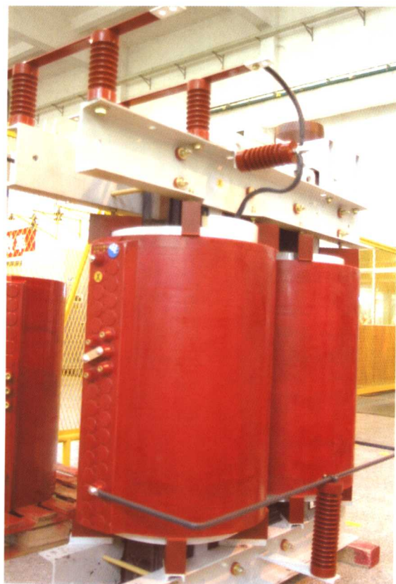
图 4-1 单相 800kVA 发电机励磁变压器
