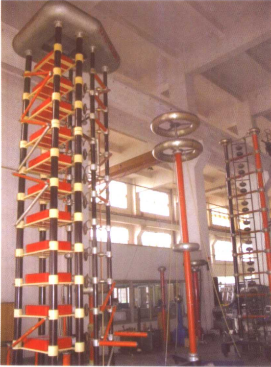
图 3-72 雷电冲击发生器及截断装置
