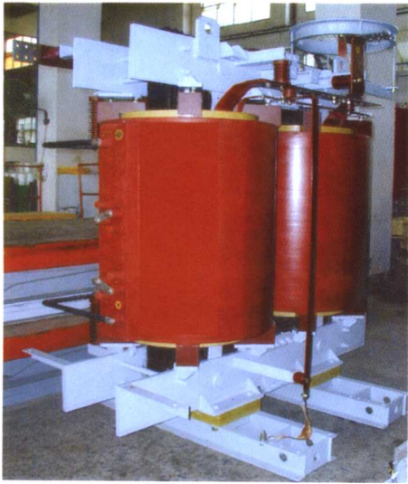
图 4-24 三峡励磁变压器 (2925kVA)
