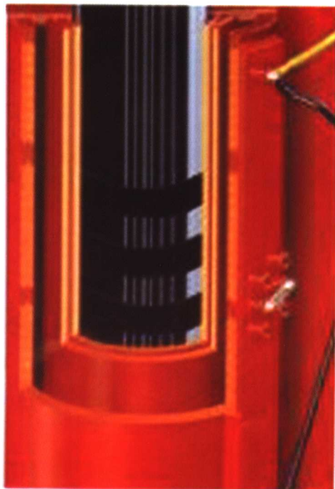
图 3-17 箔式绕组解剖图
