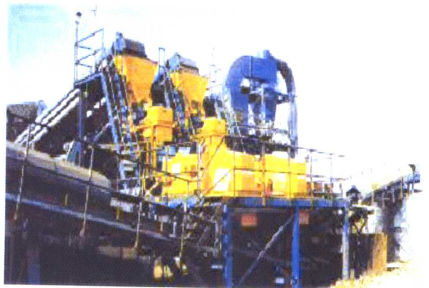
图 4-14 导体金属和固体绝缘的分选设备
