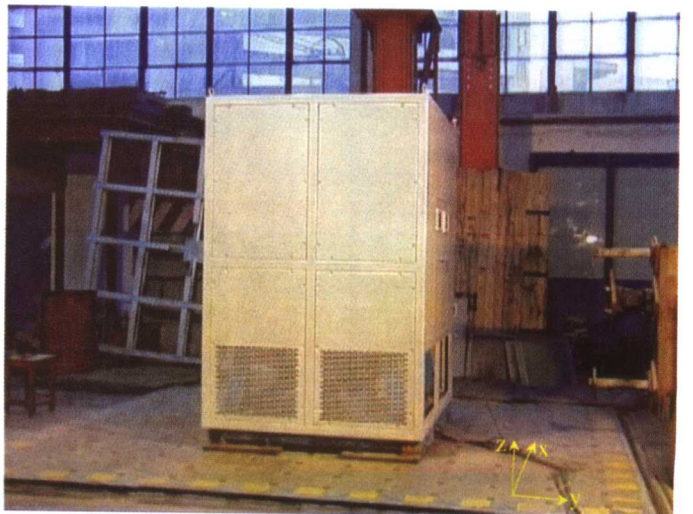
图 4-28 1E 级 SC (10) 型干式变压器 Y-Z 输入 SSE 抗震试验
