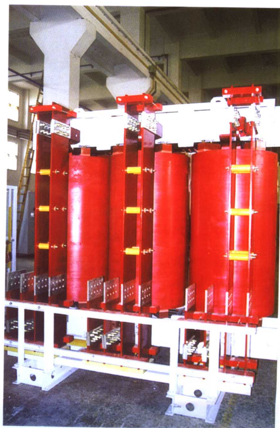
图 4-3 低压电流为 20000A 的电炉变压器
