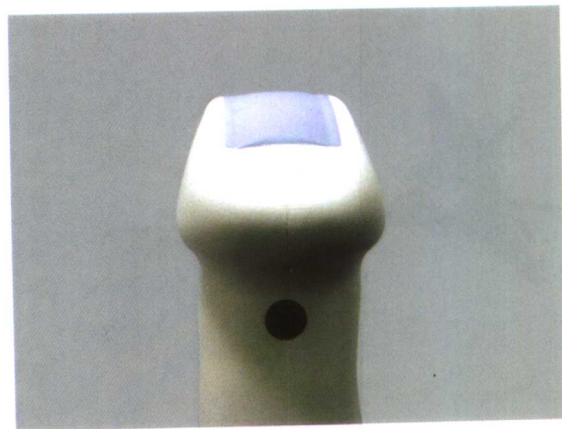
图 2-1-2 探头侧视图(注意:其声透镜呈凸形)
