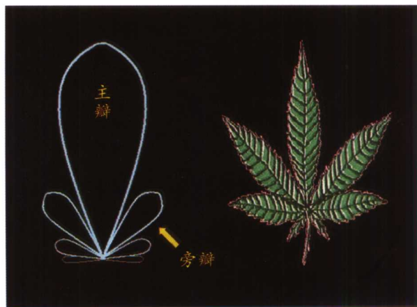
图 1-4-4 声束的主瓣和旁瓣示意图
