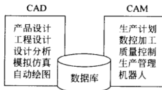
图 1-1 CAD/CAM 一体化系统的理想模式
