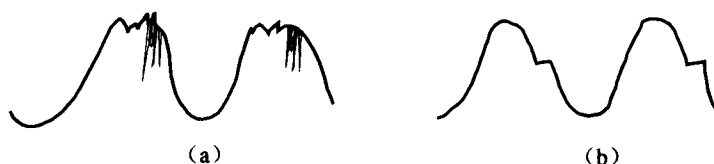
图 1-2 大信号自激的两种自激波形
