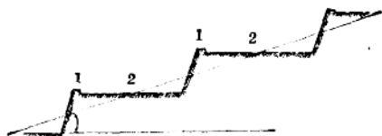
图1 水平梯田断面图
