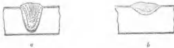
图1-5 焊缝形状对区域偏析的影响 a—窄而深的焊缝，b—宽而浅的焊缝
