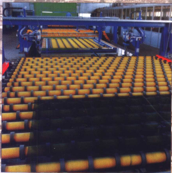
浮法玻璃生产线冷端
