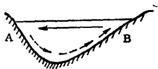
图3 河流横向环流示意图
