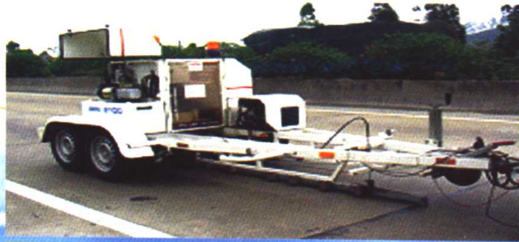
本中心的落锤式弯沉仪FWD能准确、快速地测得路面弯沉盆信息
