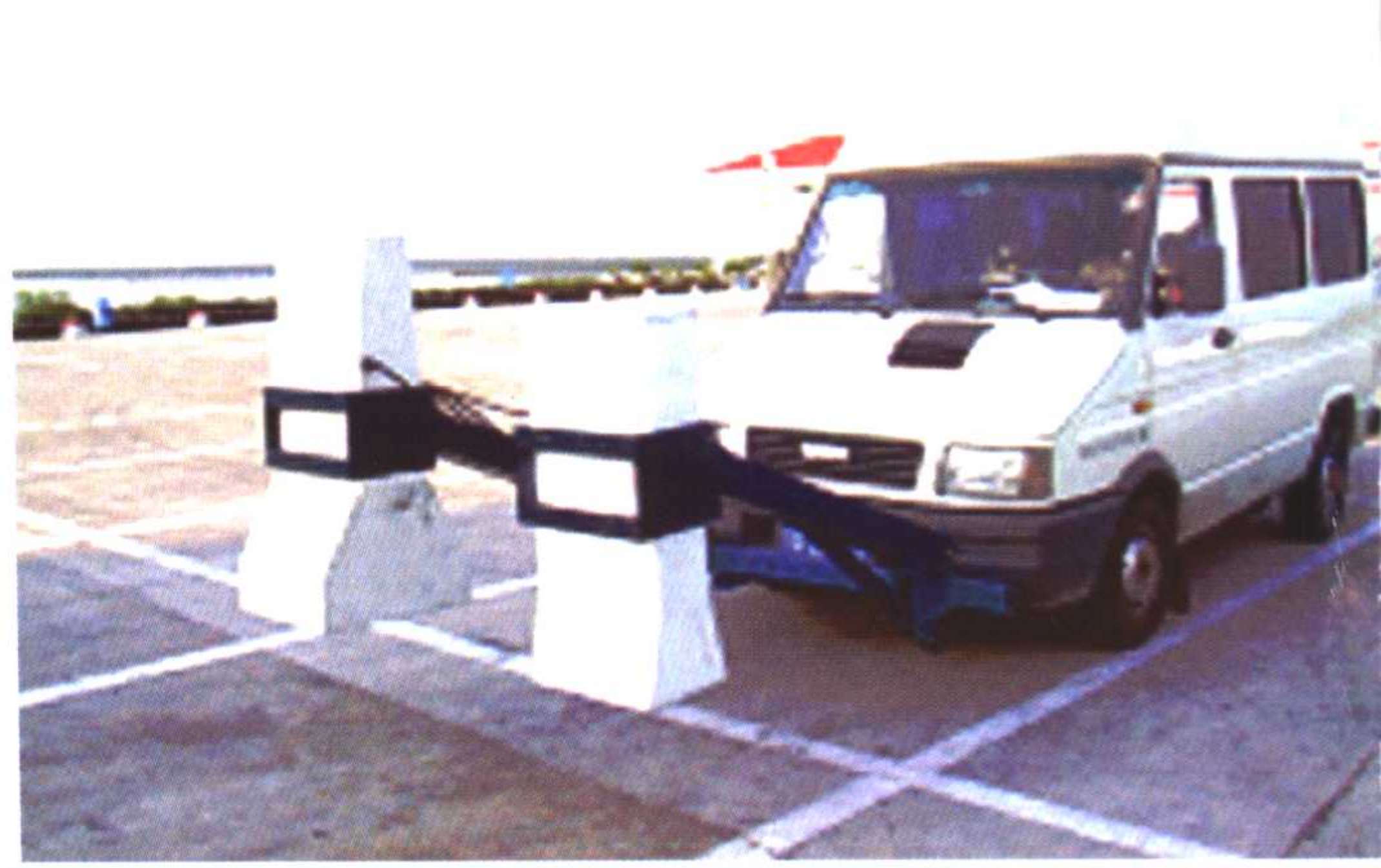
用路面雷达系统进行结构层厚度及病害检测
