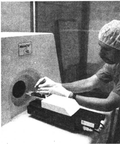
图 1-3 主要用于实验室研究的微型 CT 扫描仪
