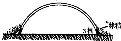
图6 小拱棚防压土伤苗措施
