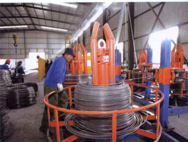
轨枕厂职工正在认真的进行钢筋冷拔作业
