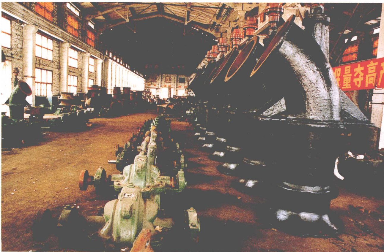
鹰潭水泵厂装配车间，该厂生产的36" ZLB型轴流泵 和 300S58 型单级双吸离心泵整机
