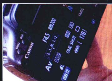
佳能数码单反相机背面结构2（曝光补偿）
