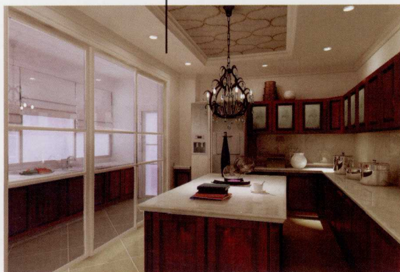
石膏板吊顶， 乳胶漆饰面
