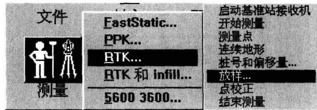
图 1-1-11 启动基准站接收机
