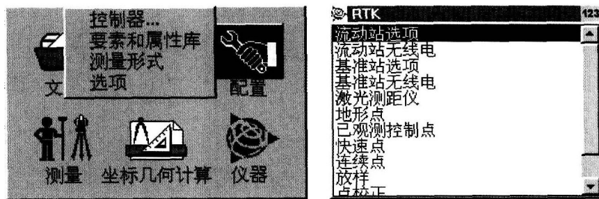
图 1-1-8 基准站选项配置步骤一
