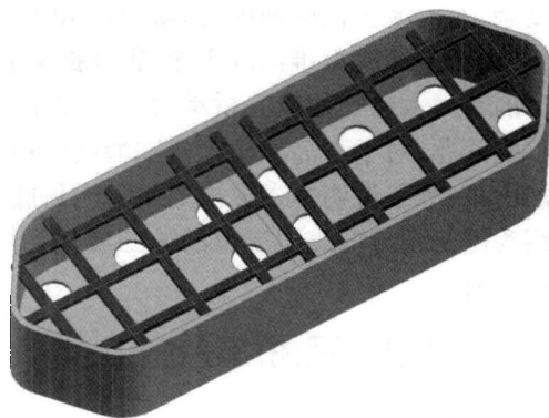
图 1-6 带钢底板混凝土套箱的两种基本形式
