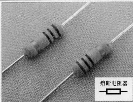
**特点：**熔断电阻器又叫保险丝电阻器，具有电阻器和过流保护熔断丝双重作用，在电流较大的情况下熔化断裂而保护整个设备不受损坏。
