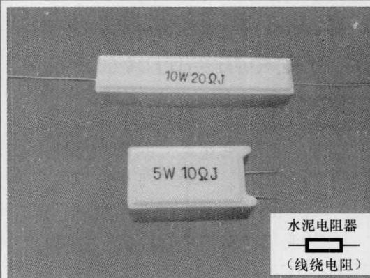
**特点:** 将陶瓷、矿质等材料进行封装而制成, 具有功率大、阻值小, 阻燃和防爆性能良好等特点。
