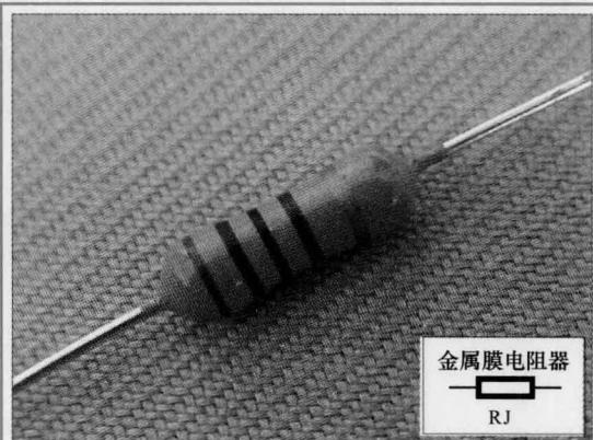
**特点：**将金属或合金材料在真空高温的条件下加热蒸发沉积在陶瓷骨架上制成。该电阻器耐高温性能高、温度系数小、热稳定性好、噪声小。
