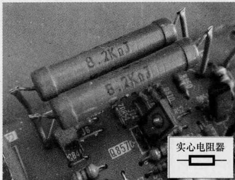
**特点：**实心电阻器是由有机导电材料或无机导电材料及一些不良导电材料混合后加入黏合剂进行压制而成的。该电阻器的阻值误差较大，稳定性较差，因此目前很少采用。
