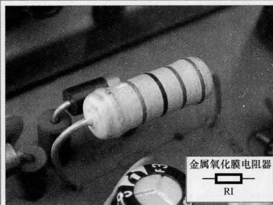
**特点:** 将锡和锑的金属盐溶液高温喷雾沉积在陶瓷骨架而制成, 具有抗氧化、耐酸、抗高温等特点。
