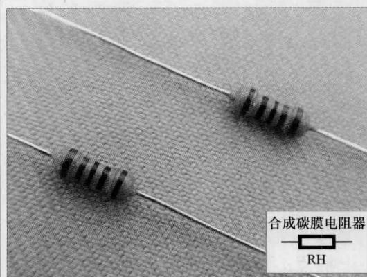
**特点:** 将炭黑、填料和一些有机黏合剂调配成悬浮液, 喷在绝缘骨架上, 再进行加热聚合而成。该电阻器为高压、高阻的电阻器, 通常外层被玻璃壳封死。
