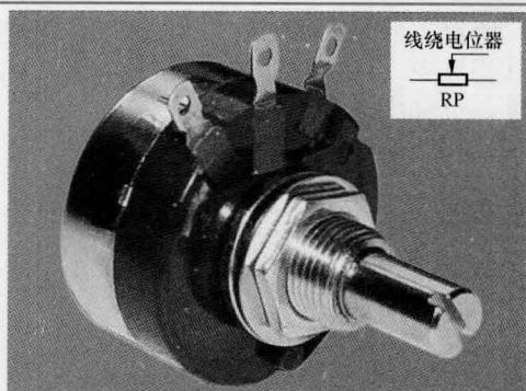
**特 点：**线绕电位器是用康铜丝和镍镉合金丝绕在一个环状支架上制成的，具有功率大、耐高温、热稳定性好且噪声低的特点，阻值变化通常为线性变化，用于大电流调节的电路中。该类电阻器由于电量大，不宜用在高频电路中。
