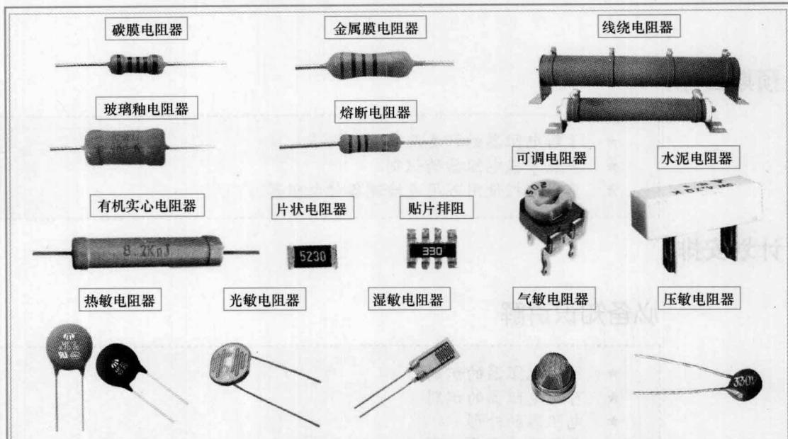
电阻器是对电路起阻碍作用的元器件，主要是显示电流的通过，通常称为“电阻”，是电子产品中最基本、最常用的电子元器件之一。
