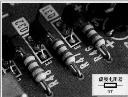
**特点：**将碳在真空高温的条件下分解的结晶碳蒸镀沉积在陶瓷骨架上制成。该电阻器稳定性好、造价低，使用广泛。
