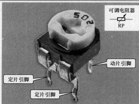
**特 点：**可调电阻器常用在电阻值需要调整的电路中。该电阻器由动片和定片构成，通过调节动片的位置从而改变电阻值的大小。
