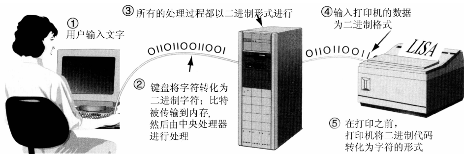
图 1-2 所有计算机内部的通信、存储以及数据处理过程在未输出到用户前都是二进制的形式
