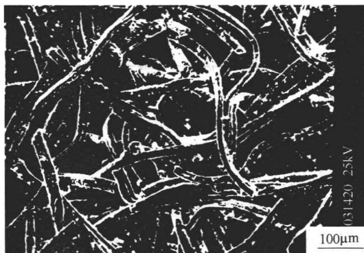
图 1-2 100% 中空纤维镍基板三维网络结构的 SEM 照片
