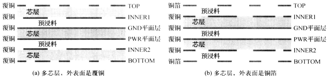
图 1-4 适用于六层板的 2 个叠层方法
