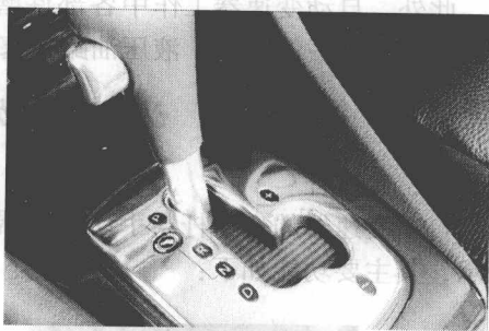
图 1-11 手自一体自动变速器变速杆
