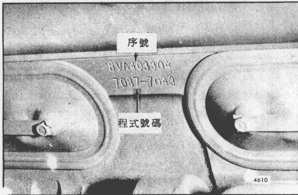
圖 4 典型引擎序號及程式號碼如印製在汽缸體上
