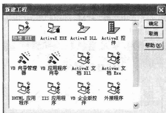
图 1-2 通过菜单打开的“新建工程”对话框
