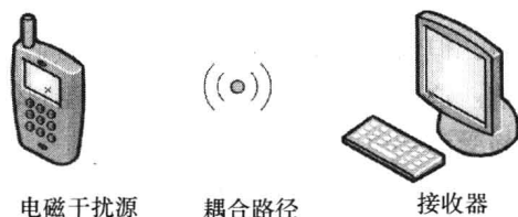
图 1-1 电磁干扰模型
