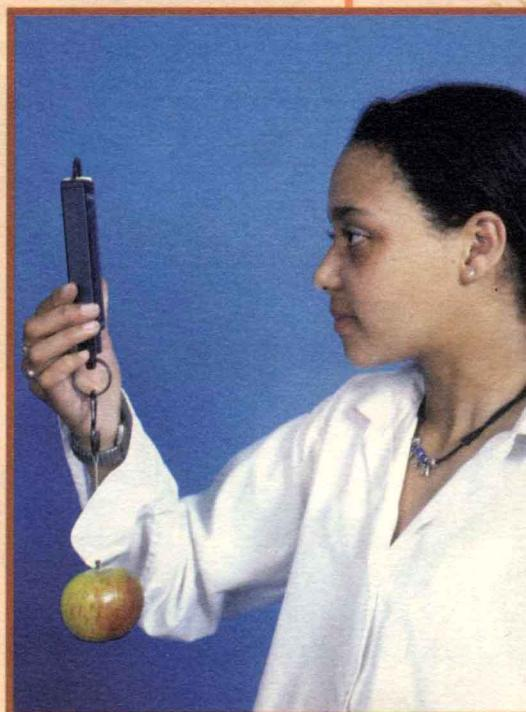
测力计或者叫牛顿计，可以测量重量或者其他的压力。图中这个学生正在测量一个苹果的力。这个苹果的重力为1牛顿。
