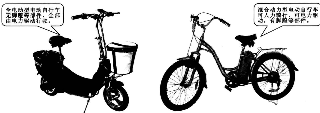
图 1-2 电动自行车的助动形式
