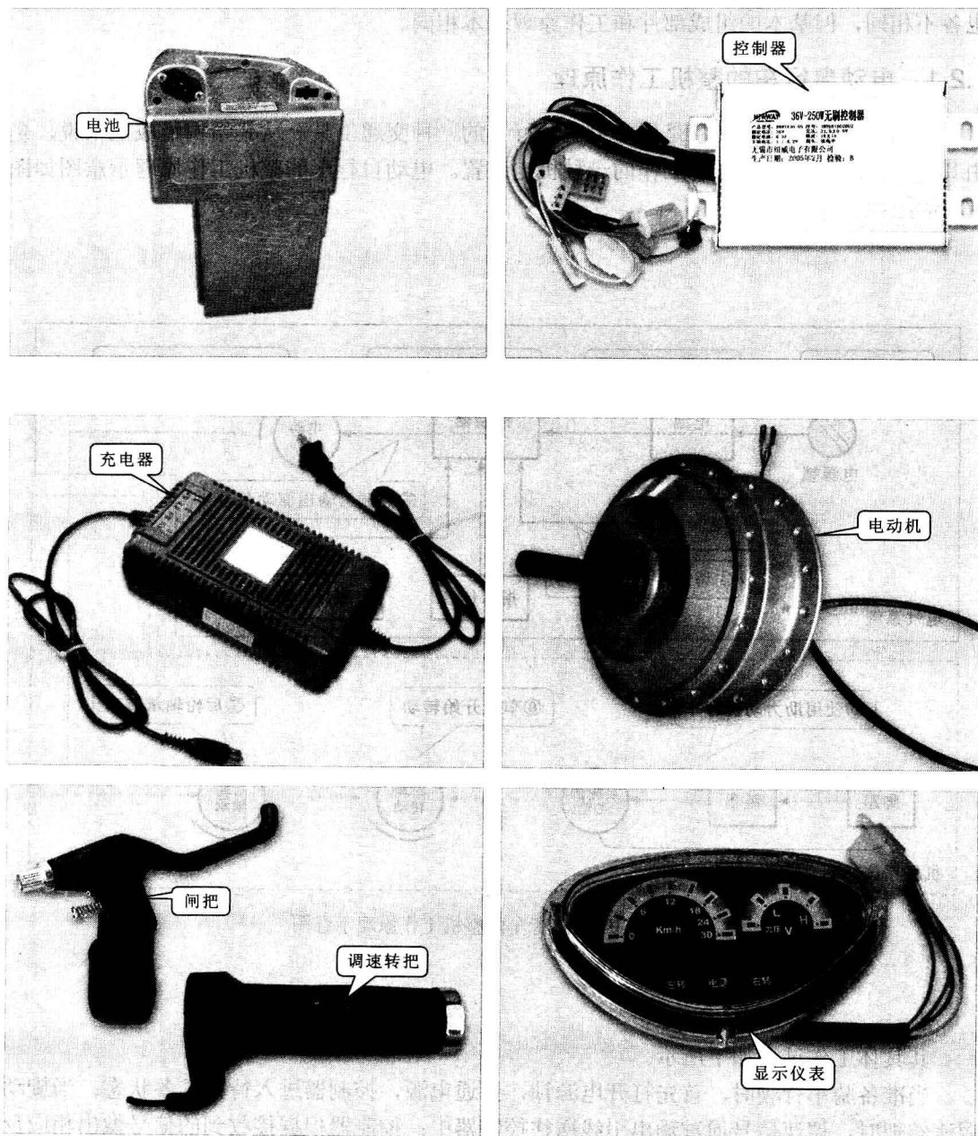
图 1-6 电气系统主要部件的实物外形
