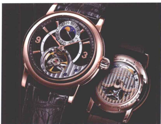
康斯登自制Heart Beat Manufacture FC935 机芯，使用矽质擒纵轮，27石，振频28,800摆。机板饰以日内瓦波纹及珍珠圆点纹，储能42小时。
