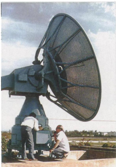
◀▼ 1979年5月，海南气象局办公楼顶安装713天气雷达。左图为雷达操纵纵台，下图为天气雷达天线。
