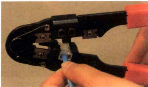
图 1-1-5 用压线钳压紧水晶头的金属压片
