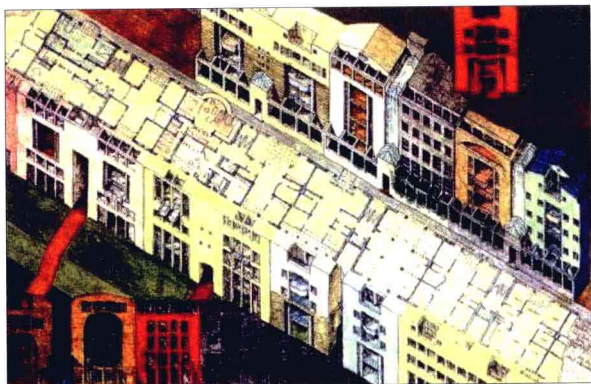
图1-1-1 著名建筑师罗伯·克利 (Rob Krier) 参加柏林IBA国际住宅设计竞赛的彩色铅笔轴测图，此图既没有用艳丽丰富的“配景”，也没有画上绚烂的“名车”，但却清晰地表达了建筑的外立面造型、色彩、建筑之间的总体关系甚至是平面布局。因此让他一举成为设计大赛的明星，并在柏林留下了许许多多不朽的作品。
