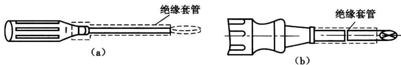
图 1.3 螺丝刀 (a)一字形 ;(b)十字形
